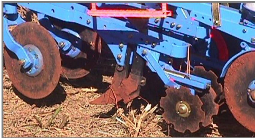
Figura 37 – Rompedores de solo da PDM 9810 da Metasa, com discos aterradores após a haste sulcadora.
