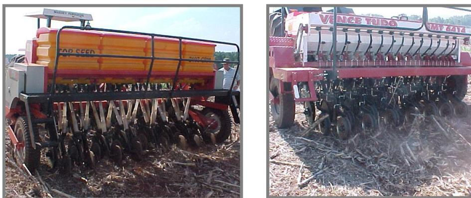
Figura 63 – Multissemeadoras na versão em fluxo contínuo, Top Seed 2407 CRM da Max à esquerda e a SMT 6414 da Vence Tudo.
