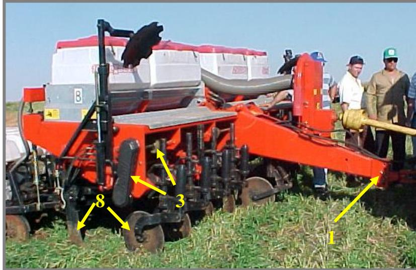
Figura 11 - Semeadora de precisão Exata 2980 da Jumil com indicação de diferentes sistemas de sua constituição.
