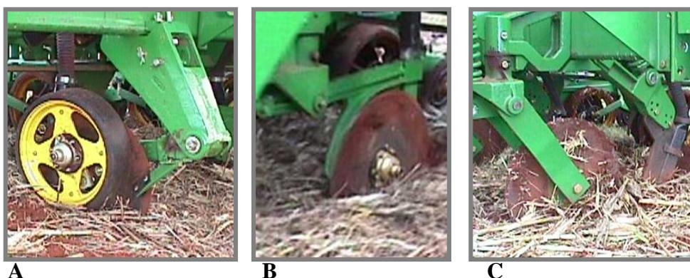
Figura 32 – Rompedores de solo com discos simples (A), duplos (B) e disco de corte e haste da semeadora 908 RT da John Deere (C).
