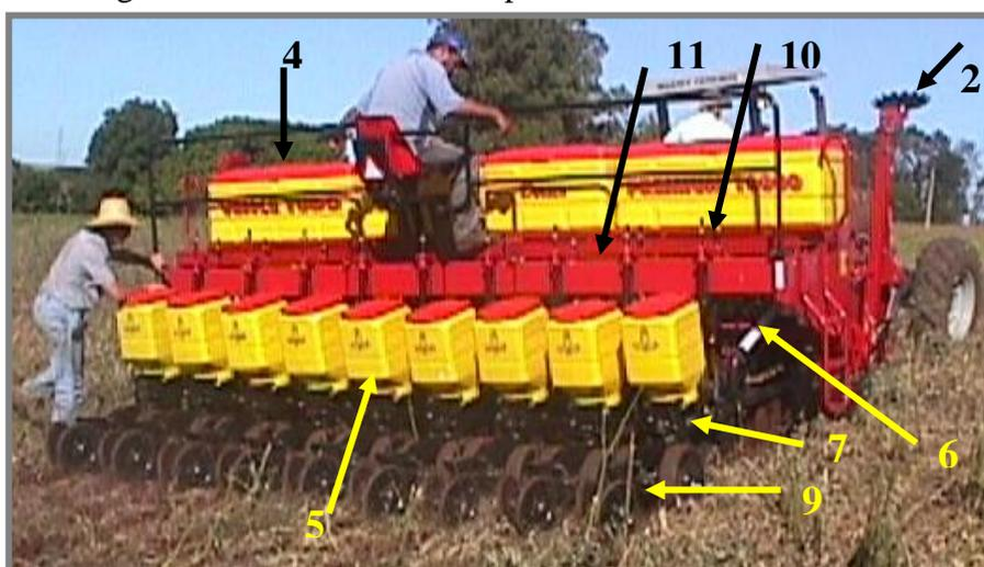
Figura 10 – Semeadora de precisão Premium 10.000 da Vence Tudo com indicação de diferentes sistemas de sua constituição.
