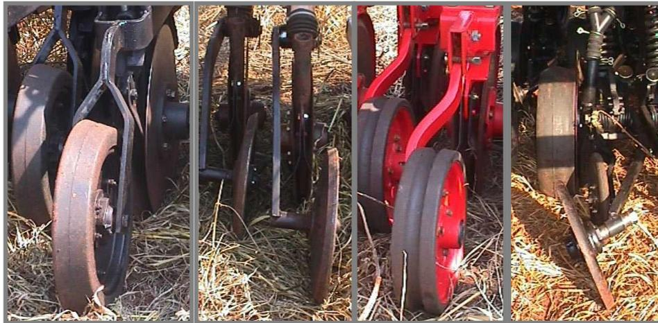
Figura 64 – Diferentes tipos de rodas aterradoras e compactadoras de máquinas do mercado nacional estudadas pelo IAPAR.
