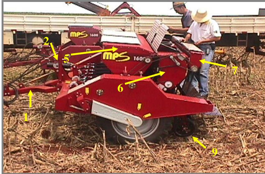
Figura 58 – Multissemeadora MPS 1600 na versão em fluxo contínuo da Imasa.
