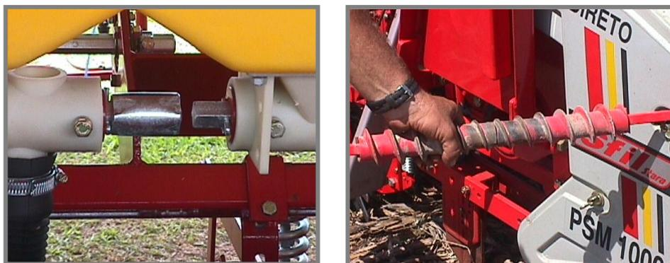
Figura 25 – Dosadores de rosca sem fim da 5030 da Fankhauser (esquerda) e PSM 10.000 da Stara/Sfil, transversais ao deslocamento da máquina.
