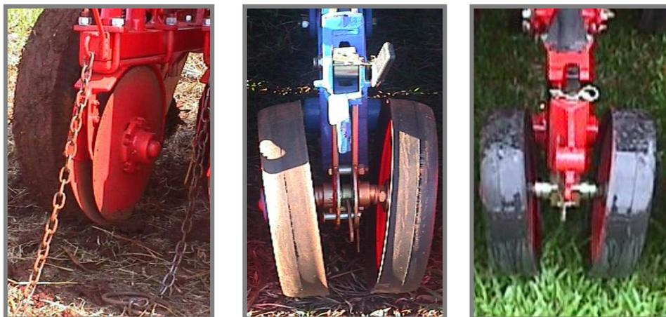
Figura 65 – Diferentes tipos de rodas aterradoras e compactadoras de máquinas do mercado nacional, estudadas pelo IAPAR. A esquerda utiliza somente correntes aterradoras.
