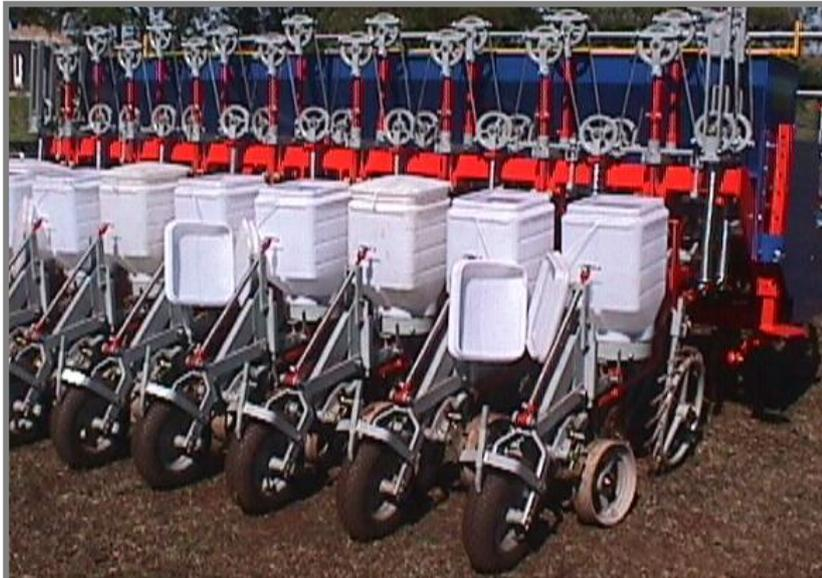
Figura 42 – Semeadora KK 8/4 com sistema de cabo de aço para transferência de força.
