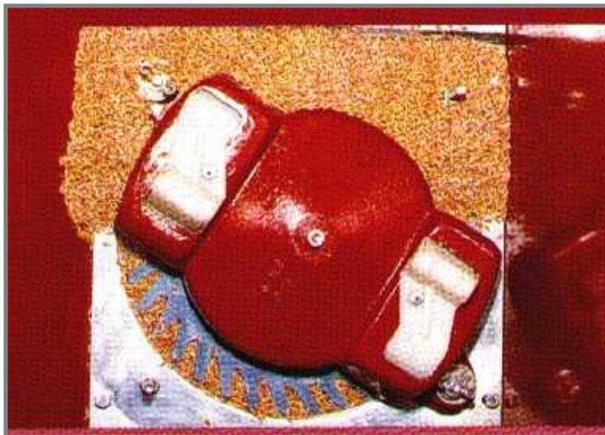
Figura 62 – Sistema de dosagem de sementes de trigo da multissemeadora MPS 1600 da Imasa.
